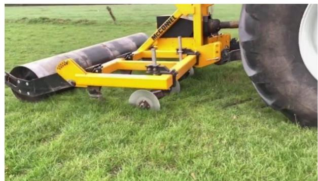
Abb. 1: Bodenlockerung mit Grünland-Tiefenlockerer,
