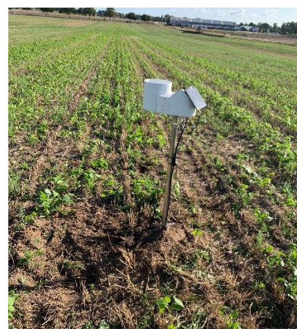
Abb. 2: verbaute Bodenwetterstation im TGG Hohenholz
