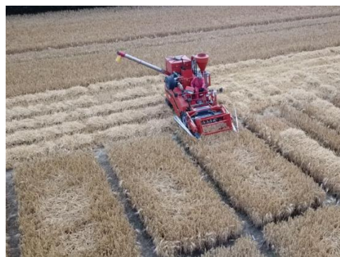
Abb. 2: Beerntung mit einem Parzellenmähdrescher
