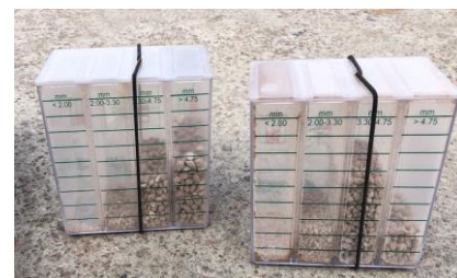
Foto 3: Schüttelbox zur Beurteilung der Korngrößenverteilung des Düngers
